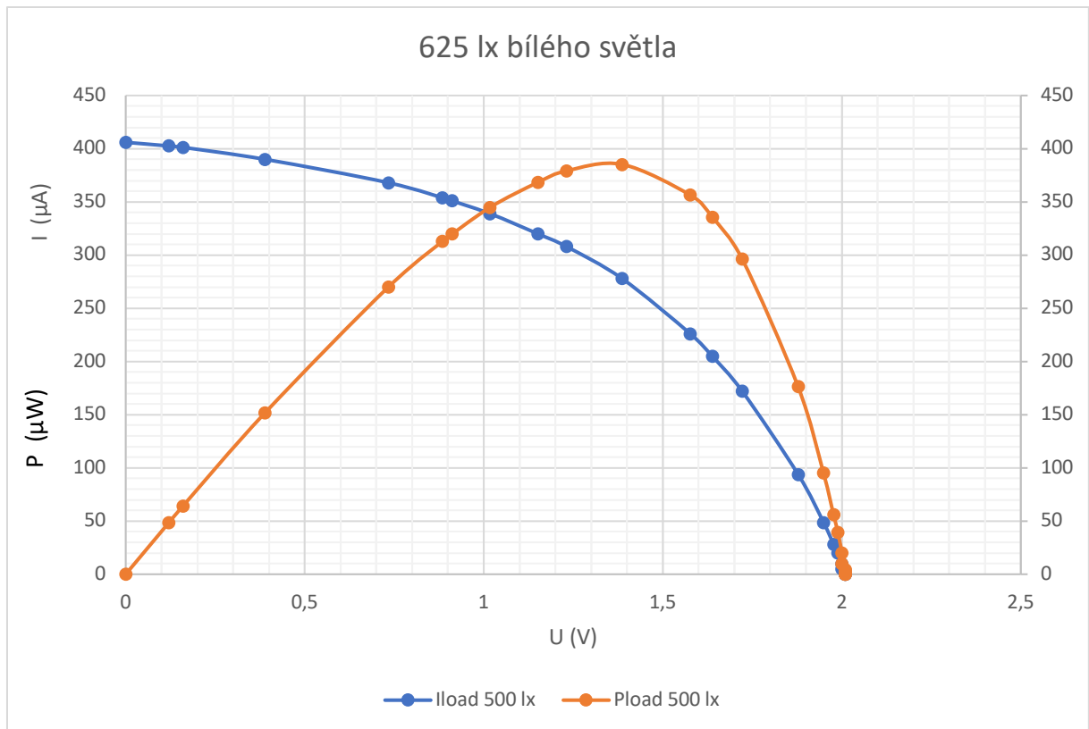
Obrázek 15. Voltampérová charakteristika panelu při intenzitě osvětlení 500 lux
